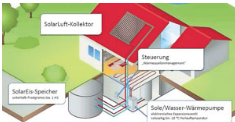
Die Grafik zeigt das Prinzip: Sonne, Erde, Luft und Wärmepumpe – und im Untergrund ein Solareis-Speicher.
